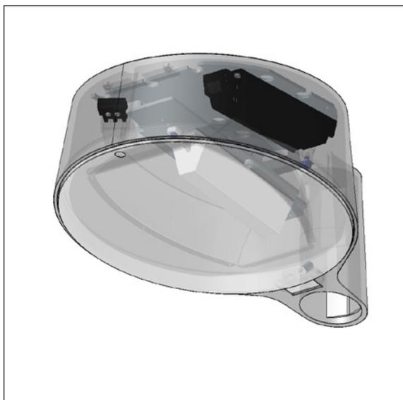
Komplettes LED Modul mit Montageplatte und Reflektor für das einfache und energieeinsparende Upgrading von **Nyx 330** Aufsatz- und Wand-Leuchten.
